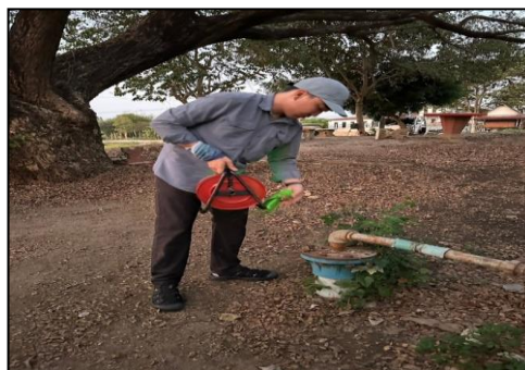
รูปที่ 3-15 การวัดระดับน้ำใต้ดิน
